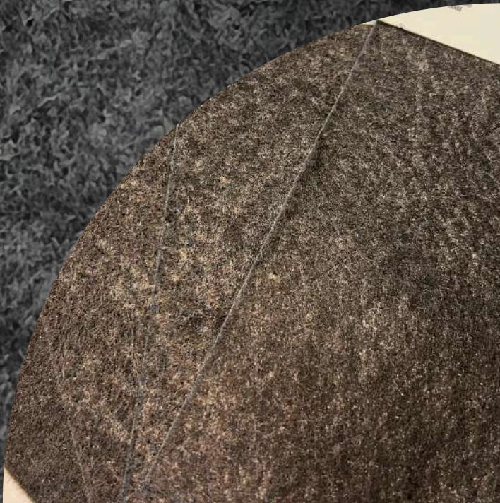
Los Geotextiles No Tejidos de Polipropileno Mirafi® Serie-N están diseñados especialmente para el drenaje de sub-superficies, la filtración y la separación de suelos. Estos geotextiles combinan alta durabilidad, altos rangos de flujo de agua y una excelente interacción con el suelo.
